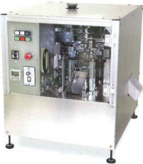
包装効率と省スペースのベストバランスを考えたロータリー式小袋包装機
