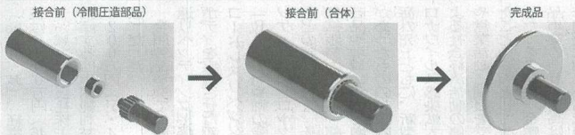
アルミニウム+鉄+銅の接合の一例
