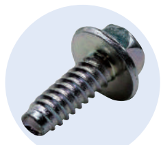
▲炭素繊維強化プラスチック用セルフタッピンねじ「CFタイト」。同社が特許を取得し、自動車の軽量化を支援するねじとして期待が高まっています。
