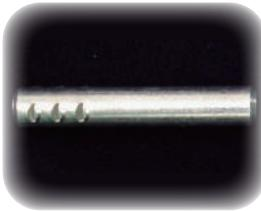
外表面の横方向に3カ所、等間隔の突起（1カ所につき縦3本）が形成されている樹脂用圧入ピンです。圧入すると、この突起が相手樹脂材に食い込み、圧入よりも大きな抜け荷重が働き、強力な抜け止め効果を発揮します。
