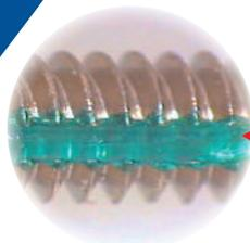
めねじにねじ込むとナイロンがおねじとめねじの隙間に押し拡げられ、ここに**ナイロンの弾性力による摩擦抵抗**が生じます。同時におねじはナイロン圧入部と反対側のめねじ面に押しつけられ、**摩擦抵抗を高め、強力なゆるみ止め効果を発揮**します。
