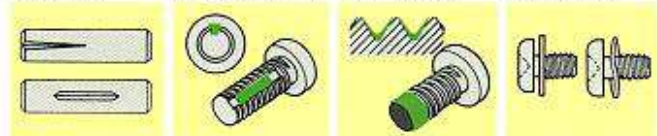
溝付形状 樹脂インサート 接着剤塗布 座金組込み
