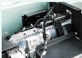
通过振动将螺丝移动到自动供给机的顶端位置。
