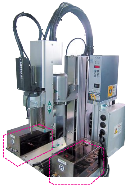
●装有2台DF200的螺丝锁付机器人
