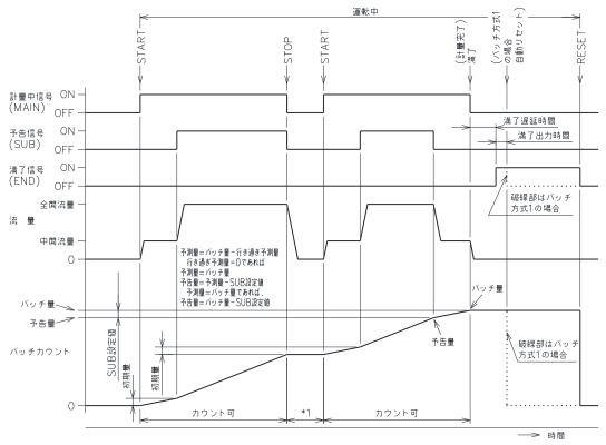
\*1:ストップ時の計数動作のデータ設定が noStoP の場合はカウント可です。
