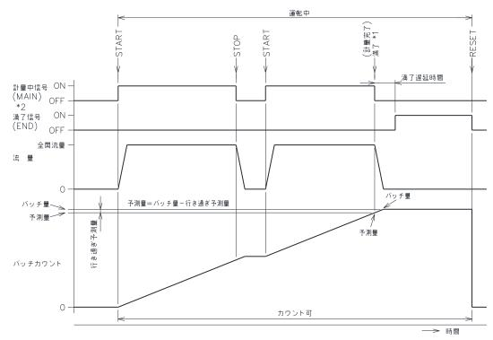
\*1:満了選択のデータ設定がバッチ量の場合はバッチ量で満了となり、満了遅延時間後に満了信号が ON します。 但し、行き過ぎ量が少なく、カウントがバッチ量に達しない場合は、満了信号が ON しません。
