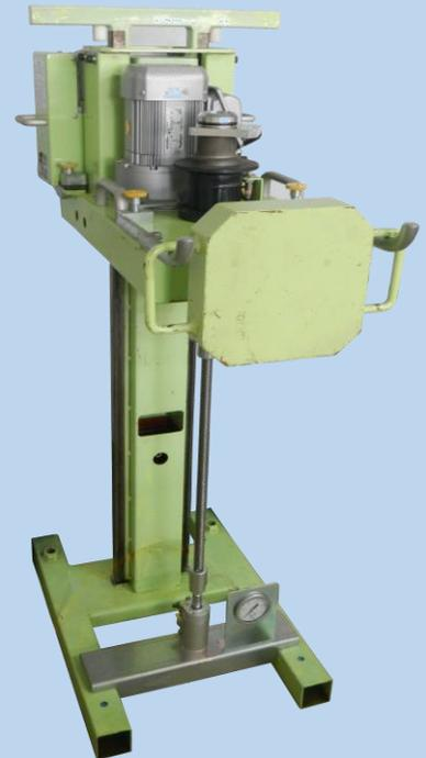
0.50kN と 1.00kN の荷重確認ができます。
