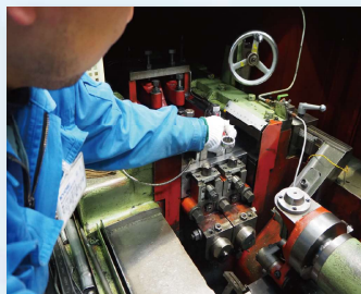
冷間圧造機械段取り替え
