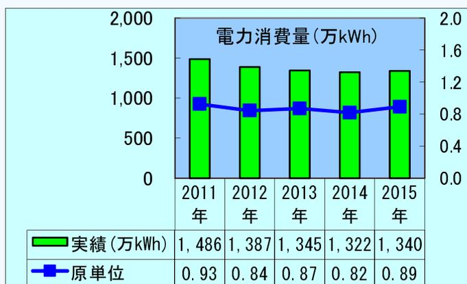
2015年も引き続き、照明器具のLED化、省エネタイプの空調機の更新を進めて参りました。また、工場の屋根に遮熱塗装を実施し、室内の温度上昇を抑制しています。
