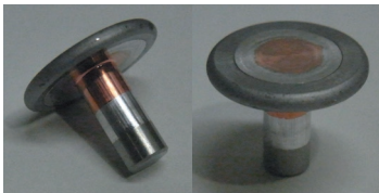
※鉄とアルミニウムと銅とステンレスの4種接合例
