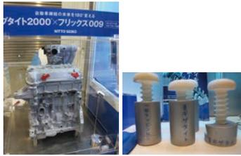
クルマの重要保安部品にもタップタイトねじが使えることを実際のエンジンを置いて展示(左)。またゆるみ止めの機構が見た目ですぐに比較できるよう「ギザタイト」の3D模型なども展示
