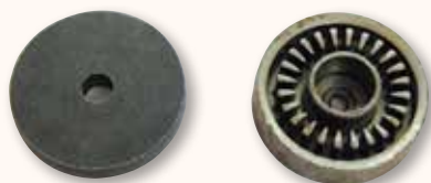
左の金属をプレスして右のように仕上げます。
