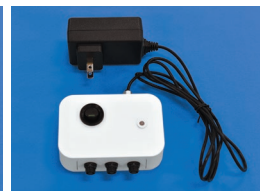
電源ボックス
