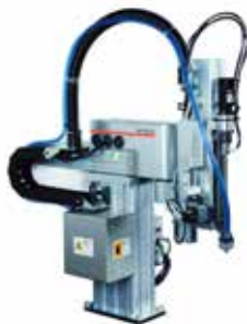
位置補正カメラ搭載 ねじ締めロボット 位置補正カメラ搭載で締付対象ワークの位置ズレを補正し、最適なねじ締めを行うことが可能なYθ型ねじ締めロボット
