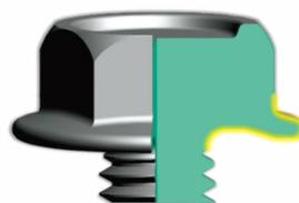
「カップボルト」は、頭部に一体成形されたフランジ部の座面が、首元から外周に向かうテーパ状のアンダーカット部と、このアンダーカット部に連なって最外周部に位置する平面部とからなるカップ形状になっています。締結時には、ここが弾性変形してばね座金のように作用するため、ばね座金・平座金を用いなくても強固なゆるみ止め効果が得られます。また、この部品点数の削減により、従来比約18%の軽量化（\*当社調べM10×40を想定）を実現しました。
